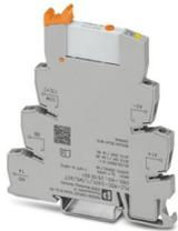
PLC-INTERFACE für Ausgabefunktionen, bestehend aus Grundklemme PLC-BSC.../ACT mit Schraubanschluss und steckbarem Miniaturrelais mit Leistungskontakt und Handbetätigung, 1 Schließer, Eingangsspannung 24 V DC
