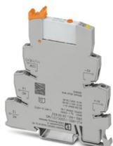
PLC-INTERFACE, bestehend aus Grundklemme PLC-BSC.../21 mit Schraubanschluss und steckbarem Miniaturrelais mit Leistungskontakt und Handbetätigung, 1 Wechsler, Eingangsspannung 125 V DC
