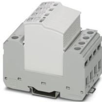
Steckbarer Überspannungsableiter, gem. Typ 2 / Class II, für 3-phasige Stromversorgungsnetze mit separatem N und PE (5-Leitersystem: L1, L2, L3, N, PE), mit Fernmeldekontakt. Mit 40 kA Ableitvermögen gemäß Anforderungen der VDE 0100-534:2016-10 an SPDs am Speisepunkt der Anlage.
