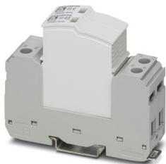
Leckstromfreier, steckbarer Überspannungsableiter, gem. Typ 2 / Class II, für 1-phasige Stromversorgungsnetze mit separatem N und PE (3-Leitersystem: L1, N, PE), mit Fernmeldekontakt.
