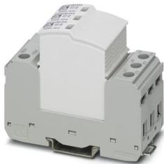
Leckstromfreier, steckbarer Überspannungsableiter, gem. Typ 2 / Class II, für 3-phasige Stromversorgungsnetze mit kombiniert verlegtem PE und N in einem Leiter (4-Leitersystem: L1, L2, L3, PEN), mit Fernmeldekontakt.
