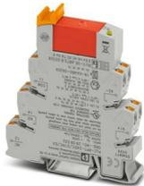
PLC-INTERFACE, bestehend aus tragschiennenmontabler Grundklemme in 14 mm mit Push-in-Anschluss und steckbarem Relais mit 10A-Leistungskontakt, 1-Wechsler, Eingangsspannung 24 V DC. Zugelassen nach ATEX/IECEX (Zone 2) und Ex-Zone Class I, Div. 2.
