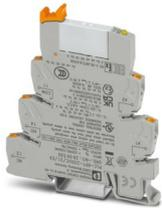
PLC-INTERFACE, bestehend aus tragschienenmontabler Grundklemme in 6,2 mm mit Push-in-Anschluss und steckbarem Miniaturrelais mit 6A-Leistungskontakt, 1-Wechsler, Eingangsspannung 230 V AC/220 V DC. Zugelassen nach ATEX/IECEx (Zone 2) und Ex-Zone Class I, Div. 2.
