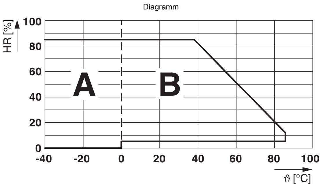
Zulässige Luftfeuchtigkeit für den Betrieb und die Lagerung.
