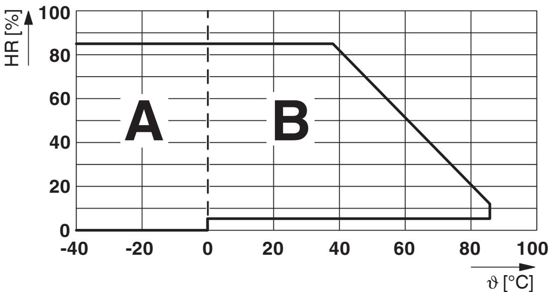
Zulässige Luftfeuchtigkeit für den Betrieb und die Lagerung.
