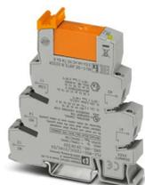
PLC-INTERFACE, bestehend aus tragschienenmontabler Grundklemme in 14 mm mit Schraubanschluss und steckbarem Relais mit 10A-Leistungskontakt, 1-Wechsler, Eingangsspannung 120 V AC/110 V DC. Zugelassen nach ATEX/IECEx (Zone 2) und Ex-Zone Class I, Div. 2.
