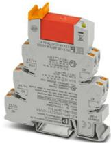
PLC-INTERFACE, bestehend aus tragschienenmontabler Grundklemme in 14 mm mit Push-in-Anschluss und steckbarem Relais mit Leistungskontakt, 2-Wechsler, Eingangsspannung 230 V AC/220 V DC. Zugelassen nach ATEX/IECEx (Zone 2) und Ex-Zone Class I, Div. 2.
