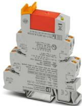
PLC-INTERFACE, bestehend aus tragschienenmontabler Grundklemme in 14 mm mit Push-in-Anschluss und steckbarem Relais mit Leistungskontakt, 2-Wechsler, Eingangsspannung 120 V AC/110 V DC. Zugelassen nach ATEX/IECEx (Zone 2) und Ex-Zone Class I, Div. 2.
