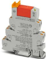
PLC-INTERFACE, bestehend aus tragschienenmontabler Grundklemme in 14 mm mit Push-in-Anschluss und steckbarem Relais mit Leistungskontakt, 2-Wechsler, Eingangsspannung 12 V DC. Zugelassen nach ATEX/IECEx (Zone 2) und Ex-Zone Class I, Div. 2.
