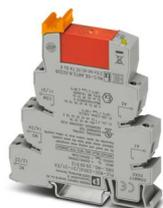
PLC-INTERFACE, bestehend aus tragschiennenmontabler Grundklemme in 14 mm mit Schraubanschluss und steckbarem Relais mit Leistungskontakt, 2-Wechsler, Eingangsspannung 230 V AC/220 V DC. Zugelassen nach ATEX/IECEx (Zone 2) und Ex-Zone Class I, Div. 2.
