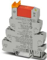
PLC-INTERFACE, bestehend aus tragschienenmontabler Grundklemme in 14 mm mit Schraubanschluss und steckbarem Relais mit Leistungskontakt, 2-Wechsler, Eingangsspannung 24 V DC. Zugelassen nach ATEX/IECEX (Zone 2) und Ex-Zone Class I, Div. 2.
