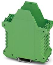
Tragschienengehäuse, Gehäuseunterteil mit Metallfußriegel, mit 2 FE-Kontakten, hohe Bauform, ohne Lüftungsschlitze, Breite: 45,2 mm, Höhe: 99 mm, Tiefe: 107,3 mm, Farbe: grün (ähnlich RAL 6021), Querverbindung: ohne Busverbinder, Polzahl Querverbinder: nicht relevant
