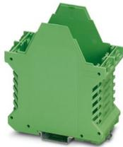
Tragschienengehäuse, Gehäuseunterteil mit Metallfußriegel, hohe Bauform, mit Lüftungsschlitzen, Breite: 45,2 mm, Höhe: 99 mm, Tiefe: 107,3 mm, Farbe: grün (ähnlich RAL 6021), Querverbindung: ohne Busverbinder, Polzahl Querverbinder: nicht relevant
