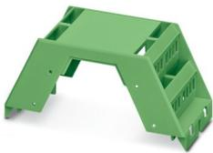
Tragschienegehäuse, Gehäuseoberteil für Leiterplattenklemmen mit Schraubanschluss, Breite: 45,2 mm, Höhe: 99 mm, Tiefe: 45,85 mm, Farbe: grün (ähnlich RAL 6021)
