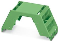
Tragschienegehäuse, Set aus Gehäuseoberteil und 8 Stk. Leiterplattenklemmen (4-polig) mit Schraubanschluss, Breite: 45,2 mm, Höhe: 99 mm, Tiefe: 45,85 mm, Farbe: grün (ähnlich RAL 6021)
