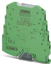
Die Einspeiseklemme MINI MCR-SL-PTB-FM(-SP) wird zur Einspeisung der Versorgungsspannung auf den Tragschienen-Busverbinder eingesetzt. Die FM-Einspeiseklemme bietet die Zusatzfunktion Überwachung in Kombination mit dem Fault-Monitoring-Modul. Schraubanschluss.
