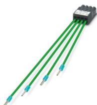
Kabelsatz zur Signalübertragung und Spannungsversorgung auf dem Termination Carrier für die Module der Serie MINI Analog und PSR mini. Anschluss der Klemmstellen 5 und 6 (Signalübertragung) sowie 7 und 8 (Spannungsversorgung) an die Signalplatine.
