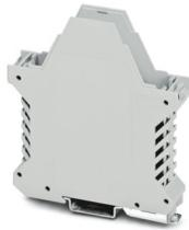
Tragschienengehäuse, Gehäuseunterteil mit Metallfußriegel, mit FE-Kontakt, hohe Bauform, mit Lüftungsschlitzen, Breite: 22,6 mm, Höhe: 99 mm, Tiefe: 107,3 mm, Farbe: lichtgrau (ähnlich RAL 7035), Querverbindung: ohne Busverbinder, Polzahl Querverbinder: nicht relevant
