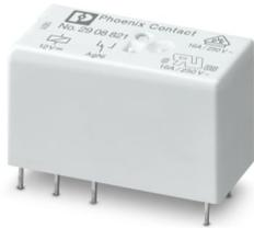
Steckbares Miniaturleistungsrelais, RT III gedichtet mit Leistungskontakten, 1 Wechsler, Eingangsspannung: 12 V DC, in Verbindung mit dem zugehörigen PLC-Sockel zugelassen nach ATEX/IECEx (Zone 2) und Ex-Zone Class I, Div. 2.
