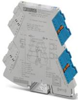
Ex i-Speise- und Eingangstrennverstärker überträgt gespeiste oder aktive 0 mA / 4 mA ... 20 mA-Signale aus dem Ex-Bereich zu einer Bürde in den sicheren Bereich. HART-transparent, Leerlaufspannung: 15 V DC, Standardkonfiguration, Leitungsfehlererkennung, Safety Integrity Level (SIL, IEC 61508): 3, Push-in-Anschluss
