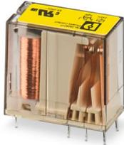
Sicherheitsrelais mit zwangsgeführten Kontakten gemäß DIN EN 61810-3, Kontaktausführung 2 Wechsler. Die Anforderungen für Typ A gemäß DIN EN 61810-3 werden erfüllt, wenn die Beschaltung als 1 Schließer / 1 Öffner erfolgt.
