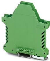
Tragschienengehäuse, Gehäuseunterteil mit Metallfußriegel, mit FE-Kontakt, hohe Bauform, mit Lüftungsschlitzen, Breite: 17,6 mm, Höhe: 99 mm, Tiefe: 107,3 mm, Querverbindung: integrierter Busverbinder, Polzahl Querverbinder: 10, Busverbinder: 10 Parallelkontakte
