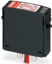
Überspannungsschutzstecker Typ 2 mit Varistor für VAL-MS-Basiselement, thermisch überwacht, optische Defektmeldung. Ausführung: 750 V AC
