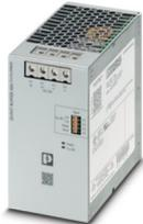
QUINT Puffermodul mit wartungsfreiem Energiespeicher auf Kondensatorbasis zur Tragschienenmontage, Eingang: 24 V DC, Ausgang: 24 V DC / 40 A, inkl. montiertem Universaltragschienenadapter UTA 107.
