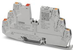
1-kanaliger, elektronischer Geräteschutzschalter zum Schutz von Verbrauchern an 24 V DC bei Überlast und Kurzschluss. Einfache Potenzialverteilung mit den Komponenten aus dem Reihenklemmensystem CLIPLINE complete. Mit elektronischer Verriegelung der eingestellten Nennströme. Zur Installation auf DIN-Tragschienen.
