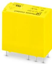
Sicherheitsrelais mit zwangsgeführten Kontakten gemäß DIN EN 61810-3, Kontaktausführung 2 Wechsler. Die Anforderungen für Typ A gemäß DIN EN 61810-3 werden erfüllt, wenn die Beschaltung als 1 Schließer / 1 Öffner erfolgt.
