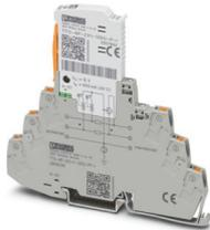
Überspannungsschutz, bestehend aus Schutzstecker und Basiselement, mit integrierter Statusanzeige für zwei Signaladern mit gemeinsamem Bezugspotenzial, z. B. Digital IN/OUT. Indirekte Erdung über Gasableiter. In sicherheitsgerichteten Kreisen bis SIL 3 einsetzbar.
