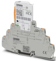
Überspannungsschutz, bestehend aus Schutzstecker und Basiselement, mit integrierter Statusanzeige für einen 2-adrigen erdpotenzialfrei betriebenen Signalkreis. Indirekte Erdung über Gasableiter. In sicherheitsgerichteten Kreisen bis SIL 3 einsetzbar.
