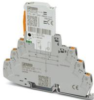
Überspannungsschutz, bestehend aus Schutzstecker und Basiselement, mit integrierter Statusanzeige für einen 2-adrigen erdpotenzialfrei betriebenen Signalkreis. In sicherheitsgerichteten Kreisen bis SIL 3 einsetzbar.
