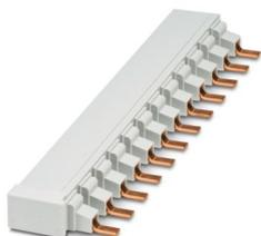
Sammelschiene für TMC 81...-Leistungsschalter (einphasig) mit Hilfsschaltermodul. 27 mm Rastermaß, bis zu 37 Pole. Ausgelegt für 80 A (Endeinspeisung), 1000 V AC/DC. UL 508-gelistet für Anschluss von Leistungsschaltern mit UL 489-Zulassung.
