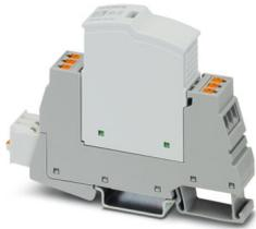
Überspannungsschutz Typ 2/3, bestehend aus Schutzstecker und Basiselement mit Push-in-Anschluss. Für einphasige Stromversorgungsnetze mit integrierter Statusanzeige und Fernmeldung. Nennspannung: 230 V AC/DC
