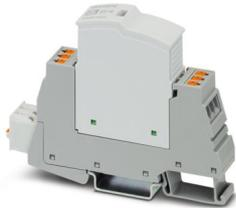
Überspannungsschutz Typ 3, bestehend aus Schutzstecker und Basiselement, mit integrierter Statusanzeige und Fernmeldung für einphasige Stromversorgungsnetze. Nennspannung 24 V AC/DC
