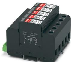
Überspannungsschutzgerät für isolierte Gleichspannungsanlagen (1000 V DC), Tragschienenmontage, 5-poliges Basiselement mit Fernmeldekontakt, 5-poliges steckbares temperaturüberwachtes Schutzsteckermodul mit Statusmeldung an jedem Stecker, zur Verwendung bei Ableitern mit drei parallelen Strings/Maximum Power Point-Trackern (MPPT).
