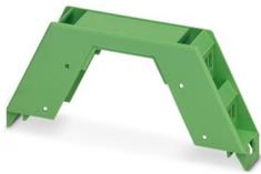
Tragschienegehäuse, Gehäuseoberteil für Leiterplattenklemmen mit Schraubanschluss, Breite: 17,6 mm, Höhe: 99 mm, Tiefe: 45,85 mm, Farbe: grün (ähnlich RAL 6021)
