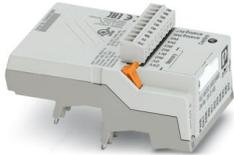
PLC logic-Stand-Alone-Modul, Generation 2, mit 16 I/Os, steckbar auf acht digitale oder analoge PLC-INTERFACE-Klemmen, nicht erweiterbar, Echtzeituhr, Micro-USB-Buchse, Aufnahme für Speicherbaustein und Bluetooth-Adapter, Schraubanschluss
