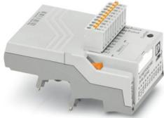
PLC logic-Stand-alone-Modul, Generation 2, mit 16 I/Os, steckbar auf acht digitale oder analoge PLC-INTERFACE-Klemmen, nicht erweiterbar, Echtzeituhr, Micro-USB-Buchse, Aufnahme für Speicherbaustein und Bluetooth-Adapter, Push-in-Anschluss
