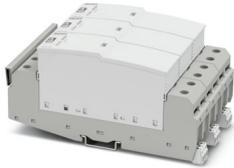
Steckbarer Blitzstromableiter, gem. Typ 1 / Class I, mit integrierter stoßstromfester Sicherung, für 3-phasige Stromversorgungsnetze mit kombiniert verlegtem PE und N in einem Leiter (L1, L2, L3, PEN).
