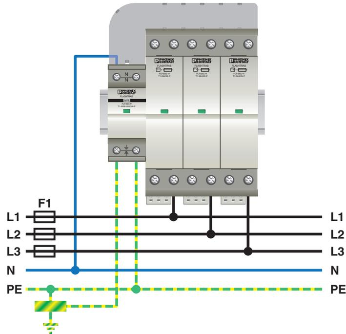
Aufbau einer 3+1-Schaltung für TN-S-/TT-Systeme mit einer N/PE-Funkenstrecke und Verdrahtungsbrücke.
