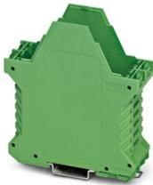
Tragschienengehäuse, Gehäuseunterteil mit Metallfußriegel, mit 2 FE-Kontakten, hohe Bauform, ohne Lüftungsschlitze, Breite: 35,2 mm, Höhe: 99 mm, Tiefe: 107,3 mm, Farbe: grün (ähnlich RAL 6021), Querverbindung: ohne Busverbinder, Polzahl Querverbinder: nicht relevant
