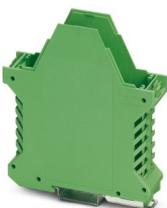
Tragschienengehäuse, Gehäuseunterteil mit Metallfußriegel, hohe Bauform, mit Lüftungsschlitz, Breite: 22,6 mm, Höhe: 99 mm, Tiefe: 107,3 mm, Farbe: grün (ähnlich RAL 6021), Querverbindung: ohne Busverbinder, Polzahl Querverbinder: nicht relevant
