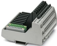
8-kanaliges VIP I/O-Marshalling-Basiselement für den universellen Einsatz. Alle Anschlüsse als Schraubanschlusstechnik. Mit dem COMBICON-Steckverbinder kompatibel zur Honeywell C300- und RUSIO-Serie. Markierung für die Kanäle 17-24.
