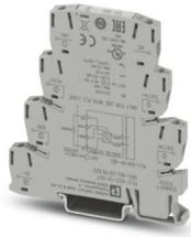
Analoges Ausgangsmodul für PLC logic-Logikmodule (nur Generation 2), 1-kanalig, Signaltyp (4 mA ... 20 mA, 0 mA ... 20 mA, 0 V ... 10 V, 2 V ... 10 V) über DIP-Schalter konfigurierbar, Schraubanschluss
