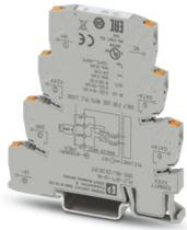
Analoges Eingangsmodul für PLC logic-Logikmodule (nur Generation 2), 1-kanalig, Signaltyp (4 mA ... 20 mA, 0 mA ... 20 mA, 0 V ... 10 V, 2 V ... 10 V) über DIP-Schalter konfigurierbar, Push-in-Anschluss
