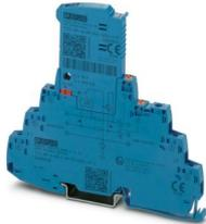
Überspannungsschutz, bestehend aus Schutzstecker und Basiselement, mit integrierter Statusanzeige und Messertrennung für einen 3-adrigen Ex-i-Signalkreis mit gemeinsamem Bezugspotenzial. Für HF-Anwendungen. Indirekte Erdung über Gasableiter, HART-fähig. In sicherheitsgerichteten Kreisen bis SIL 3 einsetzbar.
