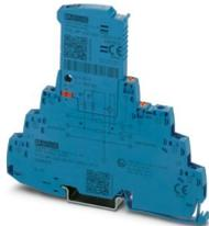
Überspannungsschutz, bestehend aus Schutzstecker und Basiselement, mit integrierter Statusanzeige und Trennmesser für einen 2-adrigen Ex-i-Signalkreis mit gemeinsamem Bezugspotenzial, z. B. Digital IN/OUT. In sicherheitsgerichteten Kreisen bis SIL 3 einsetzbar.
