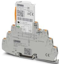
Überspannungsschutz, bestehend aus Schutzstecker und Basiselement, mit integrierter Statusanzeige und Messertrennung für drei Signaladern mit gemeinsamen Bezugspotenzial. Für HF-Anwendungen und Telekommunikationsschnittstellen ohne Speisespannung. Indirekte Erdung über Gasableiter, EX e-Zulassung für Zone 2, HART-fähig. In sicherheitsgerichteten Kreisen bis SIL 3 einsetzbar.
