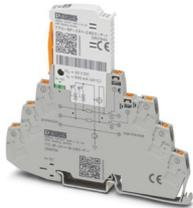
Überspannungsschutz, bestehend aus Schutzstecker und Basiselement, mit integrierter Statusanzeige und Trennmesser für zwei Signaladern mit gemeinsamem Bezugspotenzial, z. B. Digital IN/OUT. Indirekte Erdung über Gasableiter. In sicherheitsgerichteten Kreisen bis SIL 3 einsetzbar.
