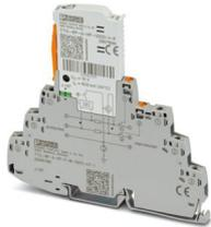
Überspannungsschutz, bestehend aus Schutzstecker und Basiselement, mit integrierter Statusanzeige und Messertrennung für drei Signaladern mit gemeinsamen Bezugspotenzial. Für HF-Anwendungen und Telekommunikationsschnittstellen ohne Speisespannung. Indirekte Erdung über Gasableiter, EX e-Zulassung für Zone 2. In sicherheitsgerichteten Kreisen bis SIL 3 einsetzbar.
