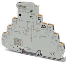
Überspannungsschutz mit integrierter Statusanzeige und Messertrennung für drei Signaladern mit gemeinsamen Bezugspotenzial. Für HF-Anwendungen und Telekommunikationsschnittstellen ohne Speisespannung (bis zu 90 MBit/s). Indirekte Erdung über Gasableiter. In sicherheitsgerichteten Kreisen bis SIL 3 einsetzbar.
