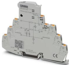
Überspannungsschutz mit integrierter Statusanzeige und Trennmesser für zwei Signaladern mit gemeinsamem Bezugspotenzial. Indirekte Erdung über Gasableiter, z. B. Digital IN/OUT. In sicherheitsgerichteten Kreisen bis SIL 3 einsetzbar.
